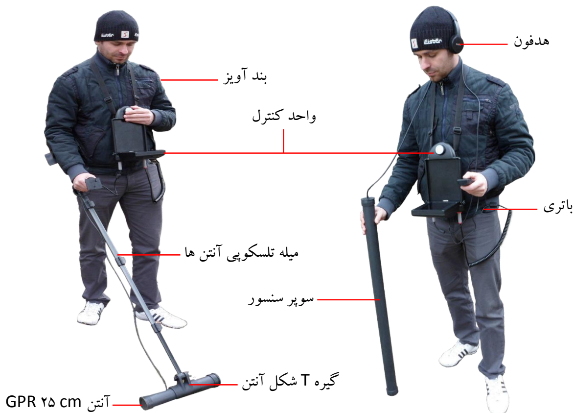
تصویر ۶-۱. قطعات کلیدی دستگاه EXP ۴۵۰۰
