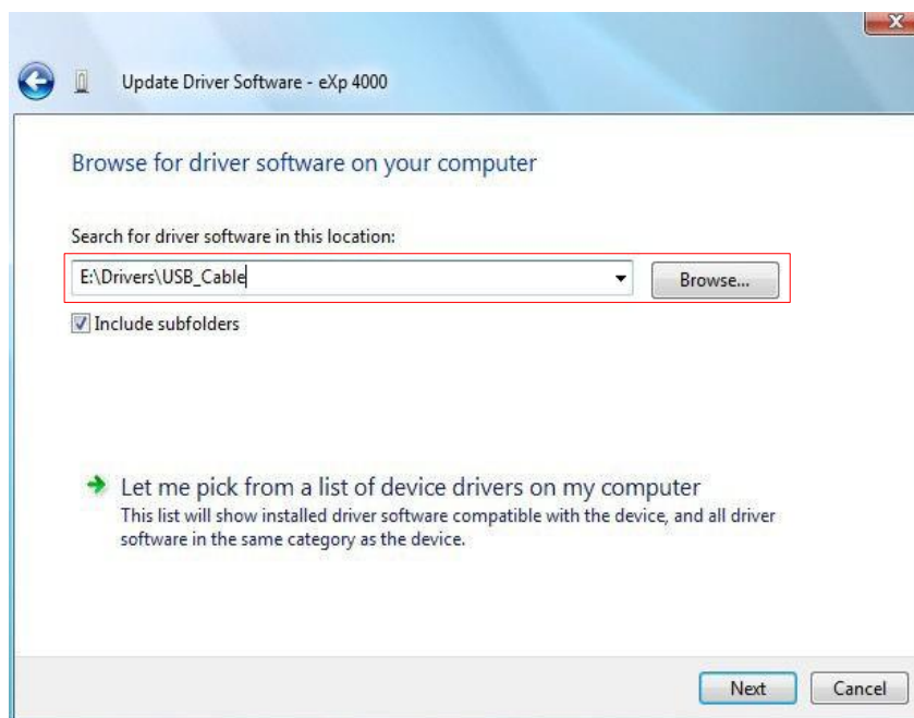
تصویر ۲-۳۳. آپدیت درایور USB بر روی ویندوز ۷، گام هشتم
