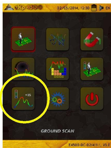
تصویر ۷-۳۷. انتخاب حالت کاربری Thermo Graph
