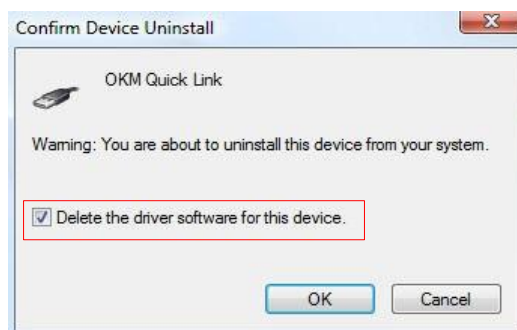
تصویر ۲-۳۷. حذف درایور USB بر روی ویندوز ۷، گام دوم
