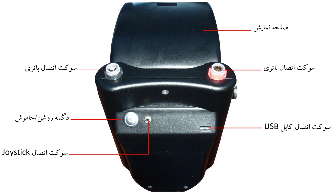
تصویر ۳-۶. نمای خلفی واحد کنترل
