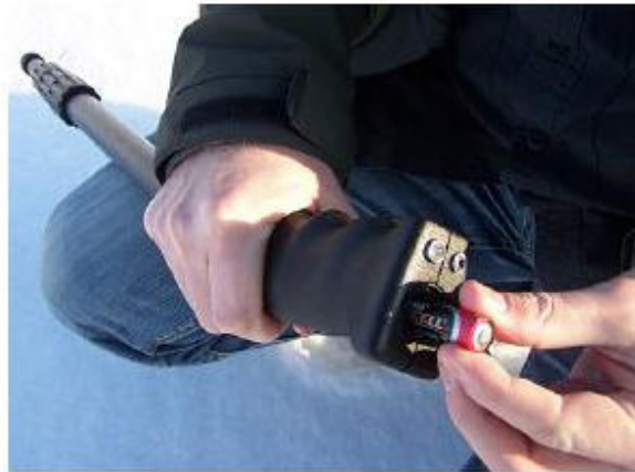
شکل ۵ . ۱ وارد کردن باتری ها درون آنتن تلسکوپیک
