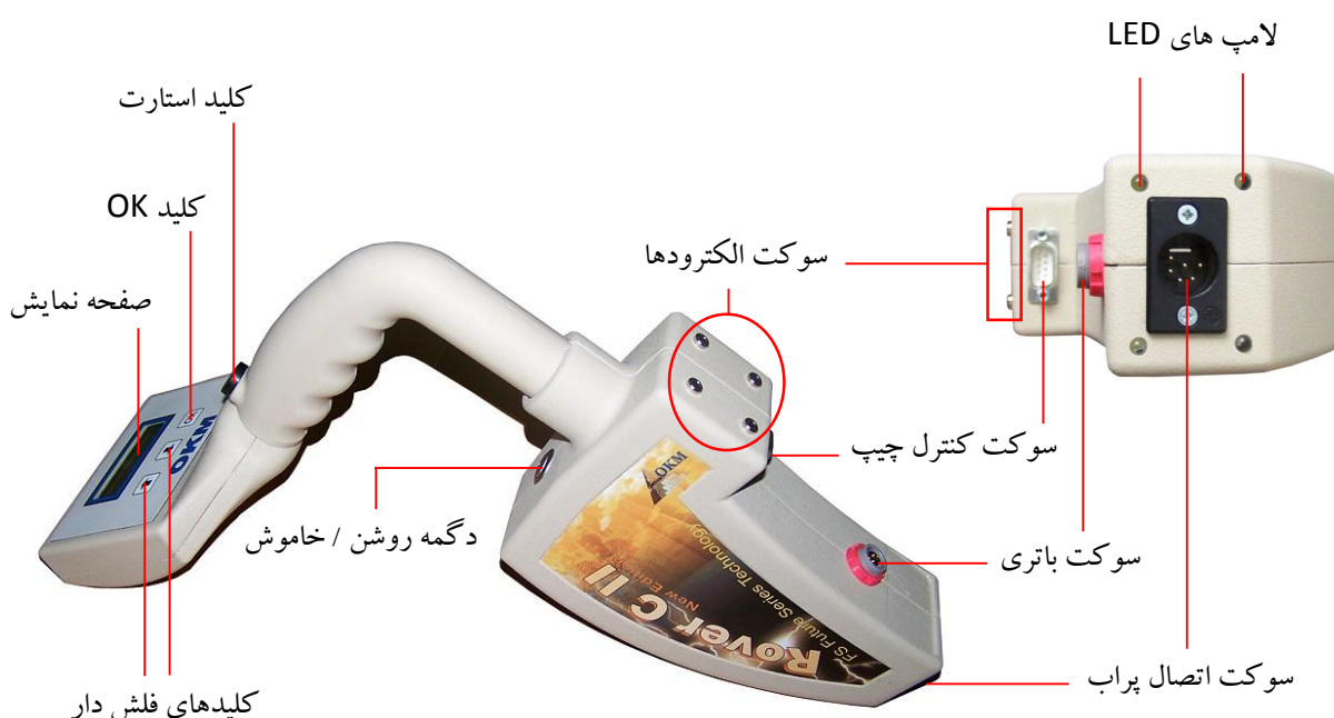
تصویر ۵-۱. اجزای واحد کنترل دستگاه
