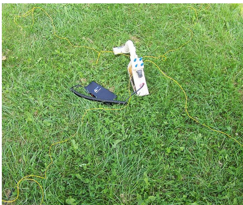
تصویر ۷-۶. حالت کاربری " حفره یاب " و اتصال الکتروودها به دستگاه
